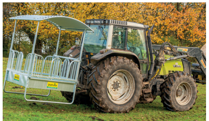
Transport über Schlepperdreipunkt, ungefüllt mit max. 10 km/h
